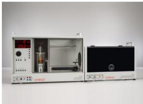
L'expérience P6.3.1.11 mesure l'atténuation des rayons X par l'évaluation quantitative d'une radiographie numérique sur ordinateur, mesure le contraste d'une radiographie numérique en fonction de l'énergie et de l'intensité des rayons X et détermine la résolution des radiographies numériques à l'aide de différentes images test.
