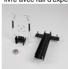
Pour l'appareil à rayons X ( 554 800 et 554 801 ), avec échelle sérigraphiée pour le positionnement défini des films pour les radioscopies, les clichés de Laue et de Debye-Scherrer ; livré avec rail d'expérimentation à échelle graduée en millimètres et diaphragme à trou (D = 1 mm) à placer sur le collimateur à fente.
