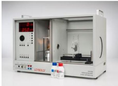
Dans l'expérience P6.3.1.2, on montre la radioscopie de certains objets avec un film à rayons X. La mesure du temps d'exposition nécessaire à un noircissement précis du film permet d'obtenir des informations quantitatives sur l'intensité des rayons X.
