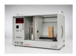
Au cours de l'expérience P6.3.1.5 on démontre l'utilisation de la radioscopie pour dépister un objet caché. Une tige en métal à l'intérieur d'un billot en bois n'est pas visible de l'extérieur, mais sur la radiographie sur lécran fluorescent on le voit très bien et l'on peut ainsi le mesurer.
