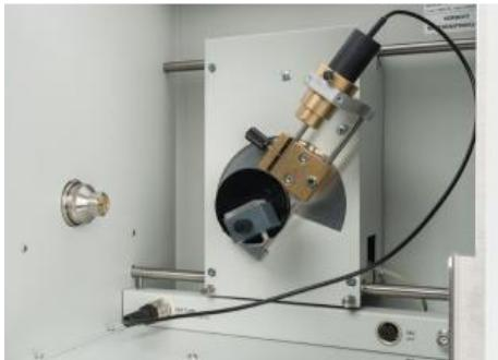
Au cours de l'expérience P6.3.3.1, on étudie la diffraction par un monocristal de NaCl des raies caractéristiques K $\alpha$  et K $\beta$  de l'anode en molybdène pour vérifier la nature ondulatoire des rayons X. Cette diffraction s'explique par la loi de la réflexion de Bragg.
