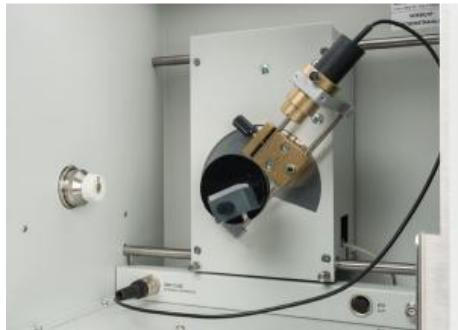
L'objet de l'expérience P6.3.3.5 est le filtrage de rayons X par la réte d'absorption dun absorbeur, c.-à-d. une transition abrupte d'une zone de faible absorption vers une zone d'absorption plus importante.
