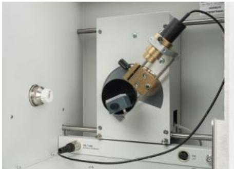
Dans l'expérience P6.3.3.6, on détermine la longueur donde des arêtes d'absorption en fonction du numéro atomique Z.
