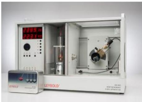
Dans les expériences P6.3.6.12 et P6.3.6.13, on étudie le rayonnement caractéristique de basse énergie de l'anode en cuivre et de l'anode en fer et on mesure la fine structure à haute résolution de la raie K $\alpha$ .
