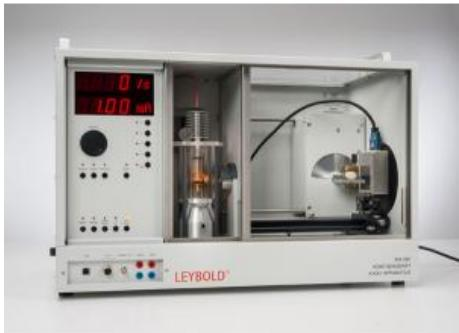
L'expérience P6.3.8.11 est consacrée aux notions de base de la tomodensitométrie (TDM) ou scanographie ainsi qu'à l'enregistrement et à la représentation des tomogrammes d'objets géométriques simples.
