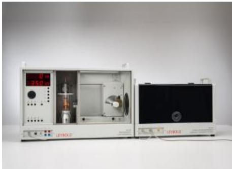
Dans l'expérience P6.3.8.4, on étudie les coefficients d'absorption de l'eau dans un corps plastique pour comprendre les possibilités offertes par la tomodensimétrie pour la différenciation des types de tissus ainsi que pour calibrer en unités Hounsfield et discuter des effets du durcissement de rayon.
