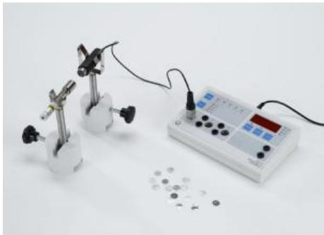
Durant l'expérience P6.4.4.2, on mesure l'atténuation du rayonnement  $\alpha$  de Sr-90 dans de l'aluminium, en fonction de l'épaisseur d'absorption  $d$ . L'expérience montre une diminution exponentielle de l'intensité.
