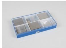
Comprend des plaquettes et des feuilles métalliques pour des expériences sur l'absorption de radiations radioactives et sur la radiation fluorescente.
