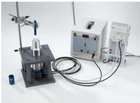
Durant l'expérience P6.5.5.5, on relève à laide du compteur à scintillations le spectre continu dun émetteur pur de rayonnement  $\beta$  ( $^{90}\text{Sr}/^{90}\text{Y}$ ).
