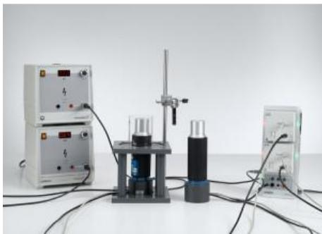
Dans l'expérience P6.5.5.6, on démontre la corrélation spatiale des deux quanta  $\gamma$  pour une désintégration du couple électron-positron.
