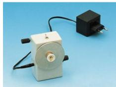
avec porte-disque et pince pour la fixation sur un support.
