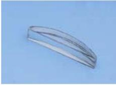
Pour des expériences en optique géométrique. Les corps sont en verre acrylique et présente une surface dépolie.
