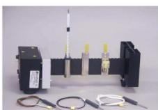
Le kit d'échangeur de chaleur TK2941H comprend une barre chauffante, trois transducteurs de chaleur et un interrupteur bimétallique ainsi que des accessoires de détection de température.
